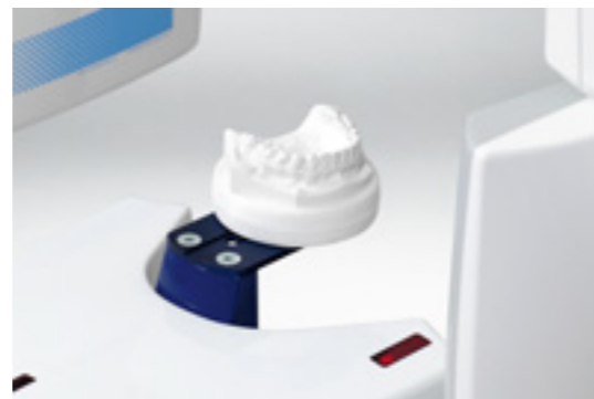
Scannen eines Gipsmodells zu einem digitalen Modell
