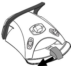
**Fußschalter:** Wenn sich alle Instrumente in ihren Haltern befinden, können Sie die Funktion Türöffner/Assistenzruf betätigen, indem Sie das Fußschalterpedal nach links schieben. Wenn Sie das Pedal länger als 0,5 Sekunden in dieser Position halten, wird die Funktion so lange ausgeführt, bis Sie das Pedal wieder loslassen.
