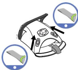
Der Fußschalter kann so konfiguriert werden, dass der Planmeca Intraoral-Scanner aktiviert wird, wenn Sie zuerst den Scanner aus dem Flexy-Halter nehmen und dann den linken oder rechten Knopf nach oben schieben. Wenden Sie sich hierzu an Ihren Planmeca-Händler.
