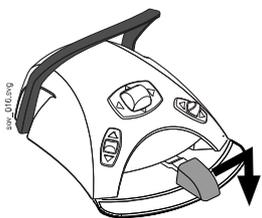
Wahlweise können Sie den Stuhl in die Spülposition fahren, indem Sie das Fußschalterpedal ganz nach rechts schieben und herunterdrücken.
