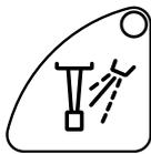
Drücken Sie **Instrumentenspray** einmal, um Wasser- & Luftspray einzuschalten. Sie hören zwei kurze Signaltöne. Zusätzlich leuchtet die Kontrollleuchte grün, um anzuzeigen, dass Wasser- & Luftspray eingeschaltet ist.
