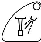
Drücken Sie **Instrumentenspray** einmal, um Wasser- & Luftspray einzuschalten. Sie hören zwei kurze Signaltöne. Zusätzlich leuchtet die Kontrollleuchte grün, um anzuzeigen, dass das Wasser- & Luftspray ausgewählt ist.
