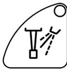
Drücken Sie **Instrumentenspray**, um die Instrumentenspray-Ergebnisse auf dem Display anzuzeigen. Die Balken im Display zeigen die Instrumente in der Reihenfolge an, in der sie in der Instrumentenkonsole platziert sind. Ein voller Balken bedeutet, dass das Instrument erfolgreich gespült wurde, und ein halber Balken, dass die Spülung für das Instrument fehlgeschlagen ist.
