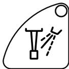
**Instrumentenspray-Taste** drücken, um das Instrumentenspray ein- oder auszuschalten. Eine Kontrollleuchte auf der Taste zeigt an, dass das Wasser eingeschaltet ist.
