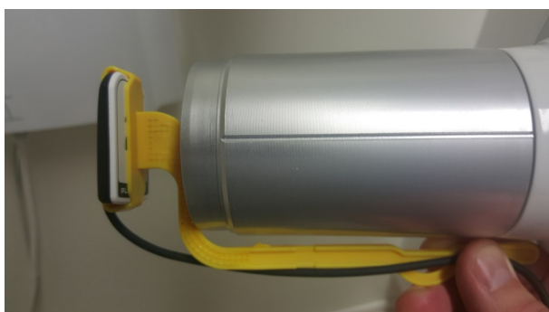
Bilde a Røntgenholder uten siktering Distanse fra røntgenhode til røntgensensor = 32cm
