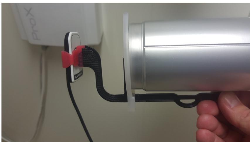
Planmeca ProSensor HD med Trollbyte Kimera bitewingholder og Planmeca ProX med rund konus
