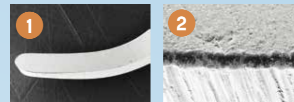
Sharp Diamond -kyretin leikkaava reuna ja sen suurennos kulumistestauksen jälkeen* (Kuvat 1 ja 2)
