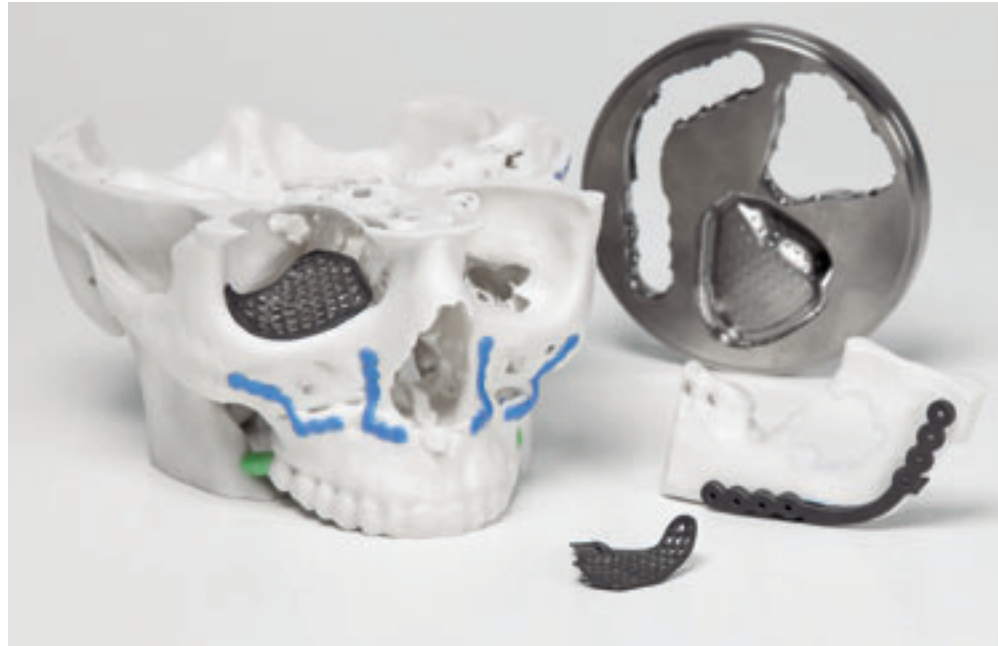
Vasemmanpuoleisella kallomallilla yksilöllinen silmänpohjaiimplantti. Oikeanpuoleisella mallilla rekonstruktiolevy.
