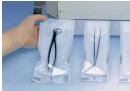
Pakkausten virheetön sulkeminen on edellytys tuotteiden steriilinä säilymiselle. Kuuma-saumaajan toiminta perustuu oikeaan lämpötilaan, saumauspaineeseen ja aikaan.
