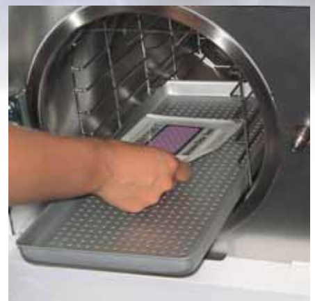
B-luokan autoklaavin ilmanpoistokyky tulee varmistaa vähintään kerran viikossa esimerkiksi Bowie-Dick-testillä. Testipakkaus asetetaan esilämmitetyn autoklaavin alimmalle hyllylle.
