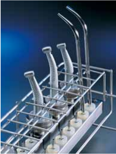
Välineiden puhdistus ja desinfiointi ovat edellytys steriloinnin onnistumiselle. Vesi pääsee kulkemaan välineiden sisälle ainoastaan, kun instrumenttipesukoneessa on suorasuihkuvaunu ja asianmukaiset adapterit tai telineet.
